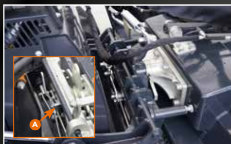
Sollevatore con aggancio rapido con leva di sicurezza (A) Front lifter with quick attachment with safety lever (A)
