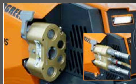
Attacchi rapidi idraulici CEJN CEJN fast hydraulic couplings
