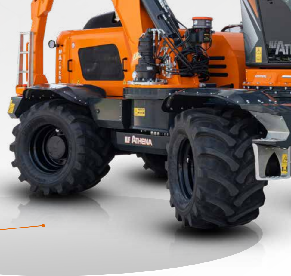
2 RUOTE STERZANTI ANTERIORI 2 FRONT STEERING WHEELS
