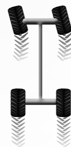
2 RUOTE STERZANTI ANTERIORI 2 FRONT STEERING WHEELS
