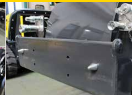
ATTACCO SOLLEVATORE ANTERIORE MECCANICO CON PIASTRA RINFORZATA FRONT MECHANIC COUPLING OF THE LIFTER WITH REINFORCED PLATE
